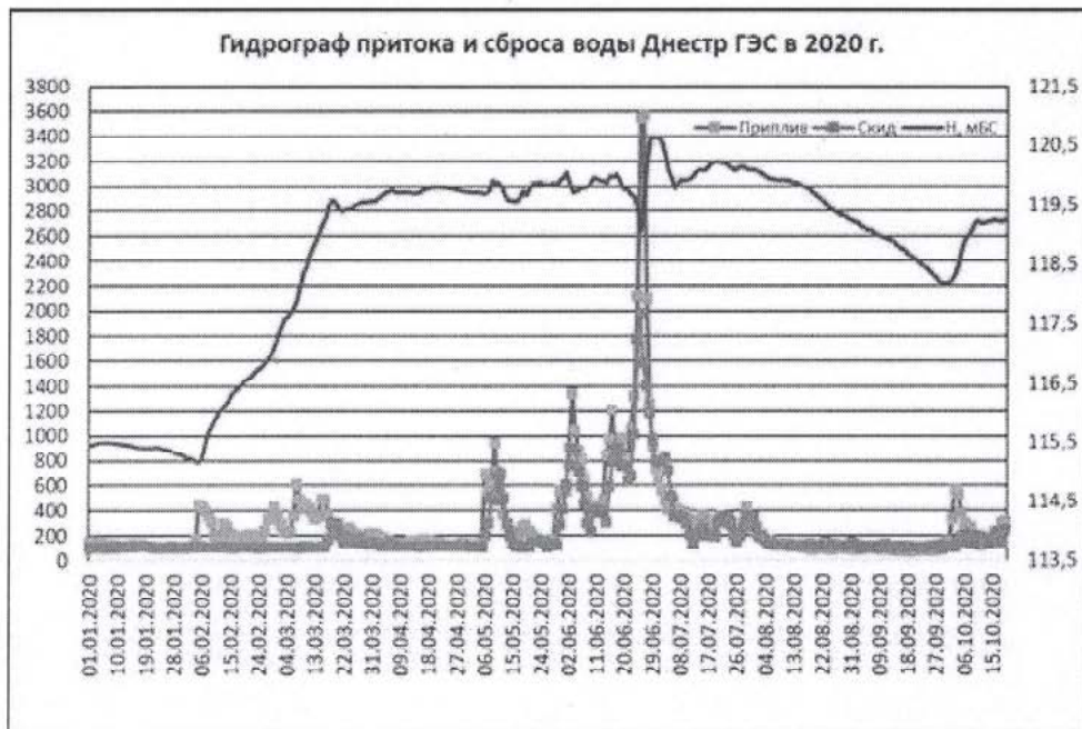
Рис. 1 Гидрографы притока и сброса воды с Днестровського водохранилища
